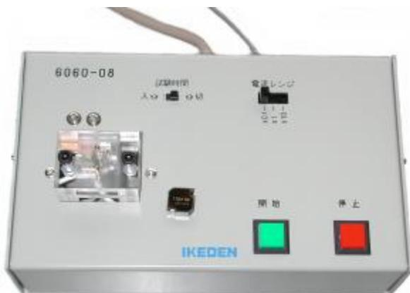
前ページの補助手段として囲まれている回路部分はこの写真の治具に収納され、リモコンの機能も付いていますので量産ラインの中で手動で試験するのに最適です。
